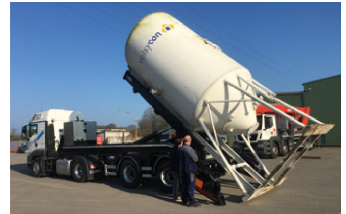
Aufnahme von Silos nach DIN 30734 am Aufnahmebeschlag
