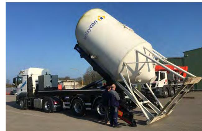
Aufnahme von Silos nach DIN 30734 am Aufnahmebeschlag
